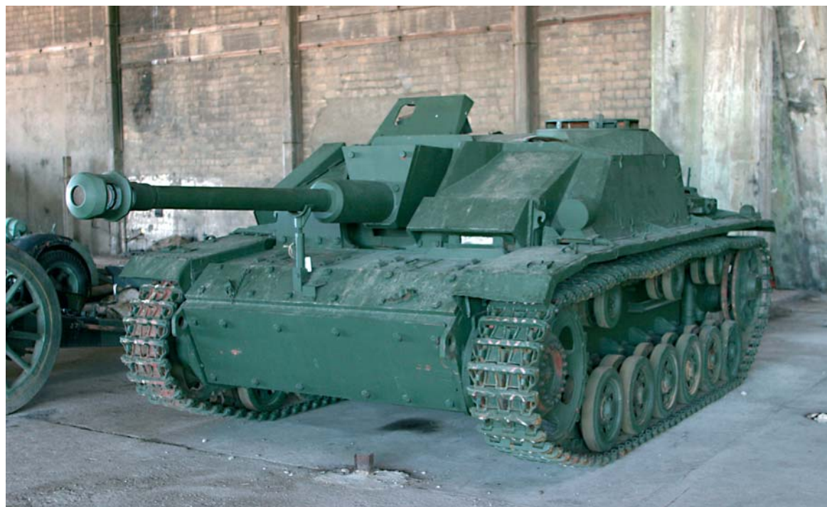
Ründesuurtükk Sturmgeschütz III Ausf G. Saksamaa enim toodetud soomusmasin II maailmasõja ajal. Relvastus 75 mm tanki- kahur StuK 40 L/48 ja 2 × 7,92 mm kuulipilduja MG 34. KLM ET 739:33 R1 152 FOTO: S. Õismaa
