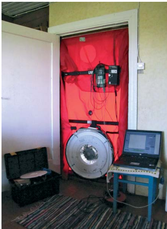
Seadeldis, millega saab mõõta hoonepiirete õhupidavust FOTO: Üllar Alev
